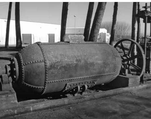
Lleixivadora horitzontal de la primitiva fàbrica de paper Alier, de Rosselló, de l'any 1893
